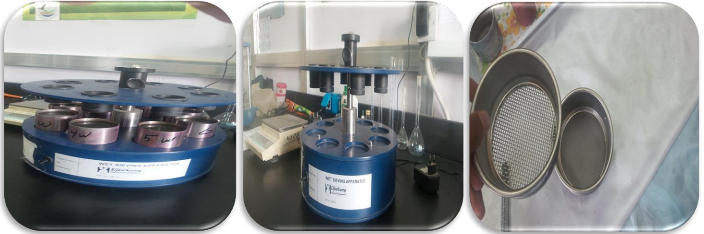
شكل رقم 6: قياس النسبة المئوية لتجمعات التربة بواسطة جهاز Wet Sieving
