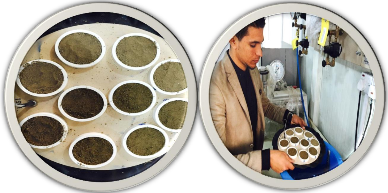
شكل رقم 7: قياس منحني الوصف الرطوبي بواسطة جهاز pressure plate
